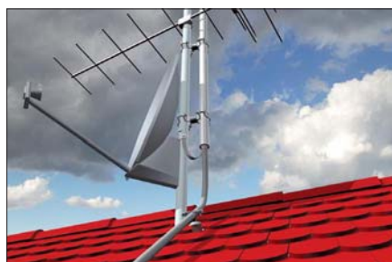
Obr. 4. Přizemnění na ekvipotenciální pospojování domku
